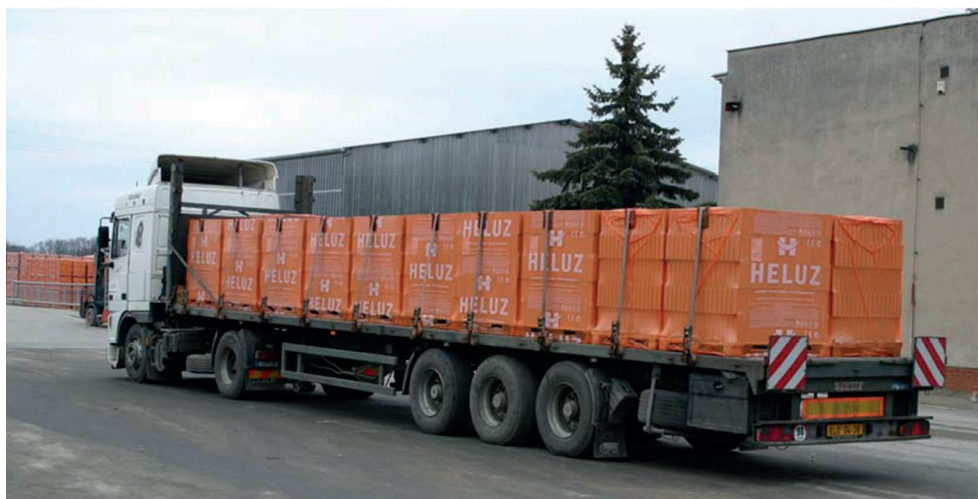
Obr. Pohľad na správne naložené palety s tehľami na nákladnom automobile
