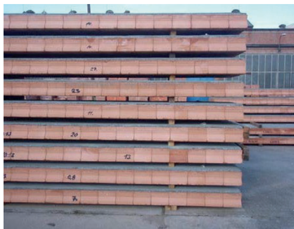
Obr. 11 Podkladové hranoly medzi jednotlivými panelmi sa umiestňujú vo zvislici nad sebou
