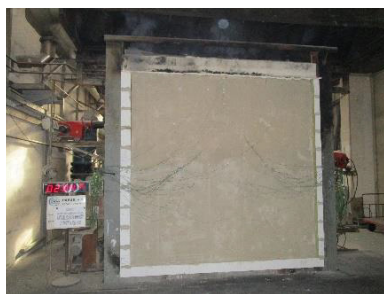
Skúška požiarnej odolnosti steny.
